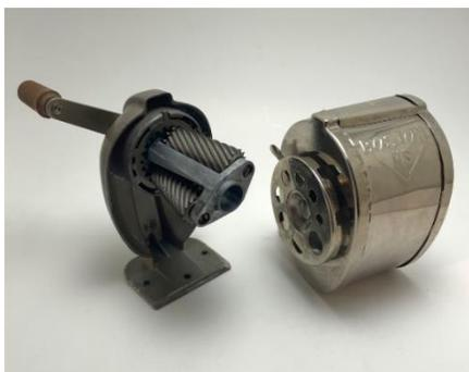
Le modèle que l'on fixe au mur, comme celui que l'on voit sur les deux photographies, est une invention du début du 20<sup>e</sup> siècle. Le boîtier renferme deux cylindres rotatifs qui rognent le crayon pour lui redonner sa belle forme conique et pointue! Il ne faut juste pas oublier de le vider de temps à autre!
